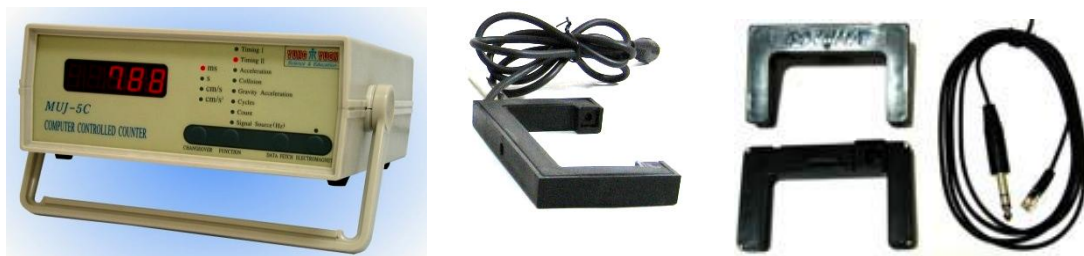
圖 1、MUJ-5C 多功能光電計時器和光電閘(Optoelectric gate)。可隨時自行放大圖片，便可清楚觀測右面板上的各項 LED 的指示和下方四個黑色按鍵的功能。
